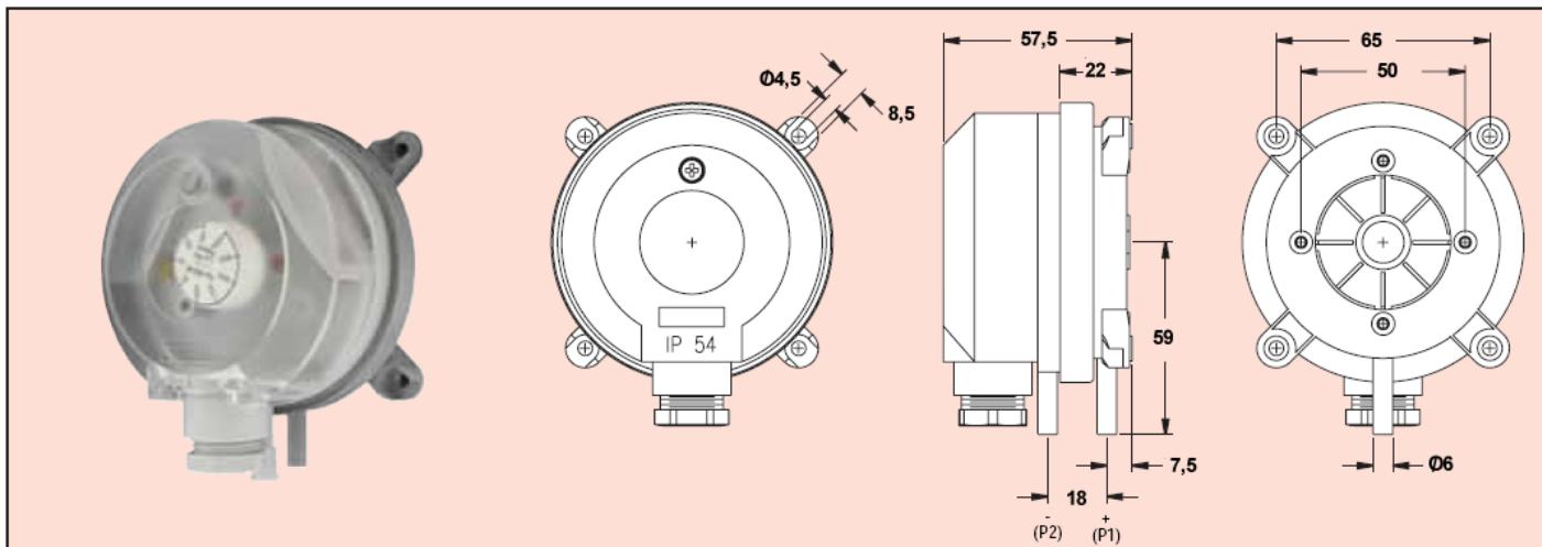
**Настраиваемое реле дифференциального давления серии ADPS** сконструировано для работы с давлением, вакуумом и дифференциальным давлением. Ручка для настройки шкалы позволяет изменить давление коммутации без использования манометра. Доступна серия ADPS с настройками от 20 Па до 4000 Па. Силиконовая диафрагма и корпус из РА 6.6 делает серию ADPS совершенной для использования с воздухом и другими негорючими газами.
